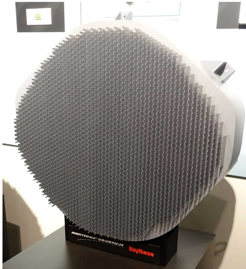
Figure 5 F-22 隐形战机用的 APG77 雷达，有 1956 个收发单元。上面蜂窝一样的结构就是收发器天线。
